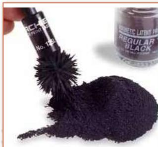
Использование стандартного магнитного аппликатора 125L
