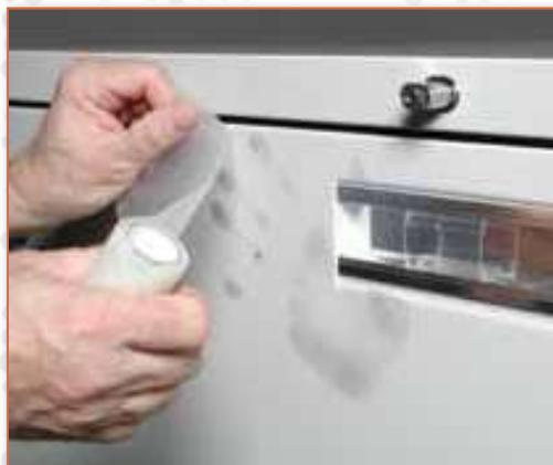
Использование пленки 144L4 при снятии следа ладони с вертикальной поверхности.
