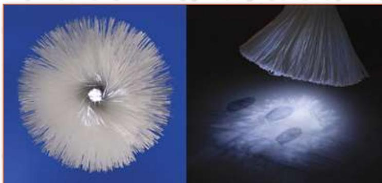
Использование стекловолоконной кисти со светоизлучающим диодом вместе с флуоресцентным порошком.
